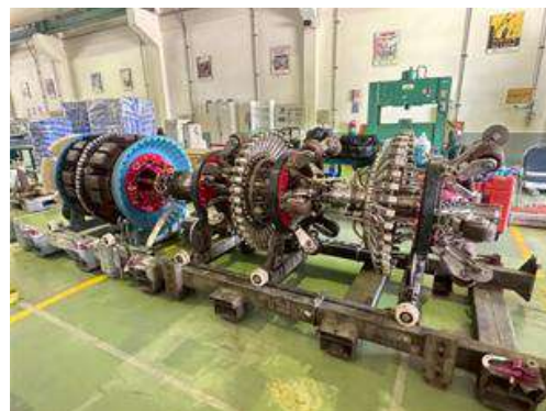
รูปที่ 2-19 การตรวจสอบการกักตรอนของผิวภายในท่อด้วยการปล่อยกระสวย (Intelligent PIG)
